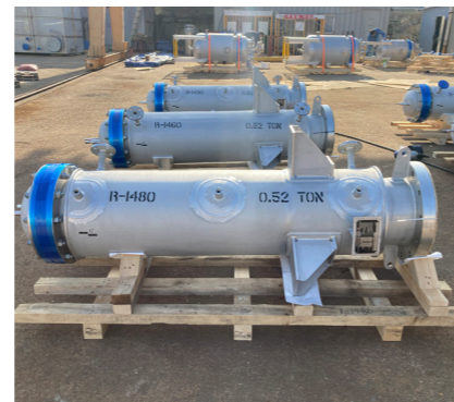
열교환기 제작 · 설치
